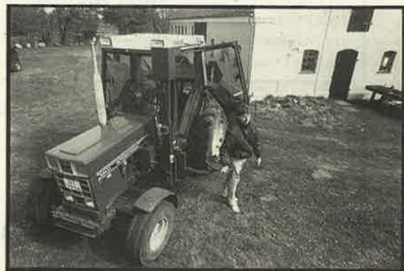
Traktoren er født med handicapvenlig servo-styring. Bremses, gear, og kobling er gjort hydrauliske, så Thomas Krysza kan betjene funktionerne med sin højre hånd.
