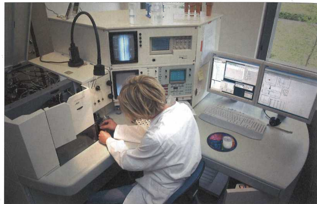
Når først cellosteringsmaskinen, som her betjenes af Ditte Andersen, er kalibreret, kan den sortere 30.000 celler i sekundet efter, hvilke proteiner der er aktive i dem.
