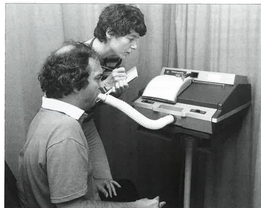
Vitalografen var en del af det udstyr, der blev brugt i forbindelse med respirationsprojekterne. På billedet fra 1989 måler Birgit Steffensen vitalkapaciteten (lungerne ydeevne) hos Flemming Nickel.
