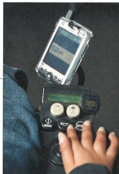
Mobiltelefonen for bevægelseshandicappede kan monteres på kørestolen og betjenes af en 01-kontakt eller som her et joystick.
