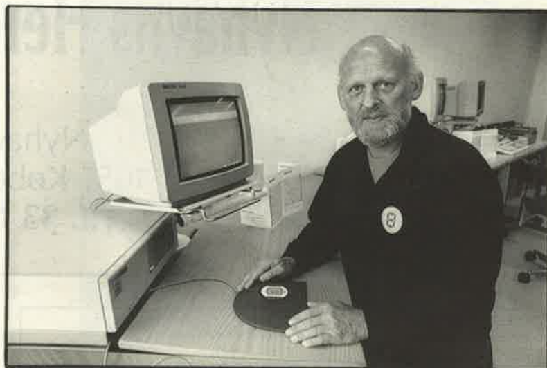
Seven-Key leveres i forskellige design alt efter brugerens behov. Egon N. Sørensen (tastaturets opfinder) demonstrerer her, hvordan det runde tastatur kan monteres i en håndstøtte.
