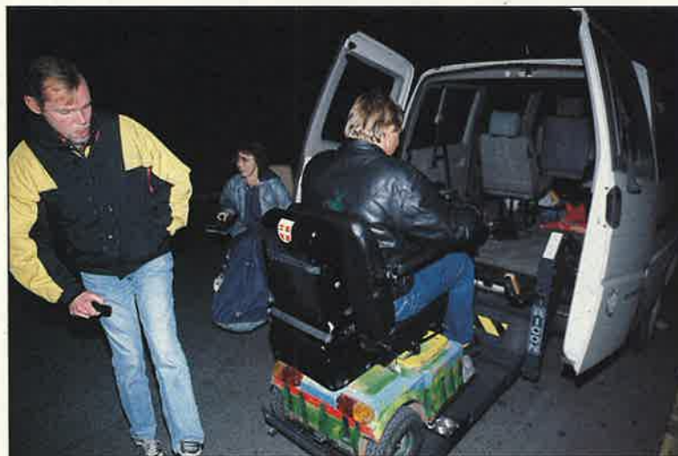
Klaus Rosenlund (på bilens lift) bliver grøn af misundelse over det smarte liftsystem i Lars Dahls køretøj. Det hydrauliske system er smart, fordi det styres fuldstændig af den remote-controller, han har i hånden, og fordi ind- og udkørsel går meget hurtigt. Inde i bilen kan han straks sætte sig på førersædet. Klaus har et system, som bruger fem minutter på en læsning.
