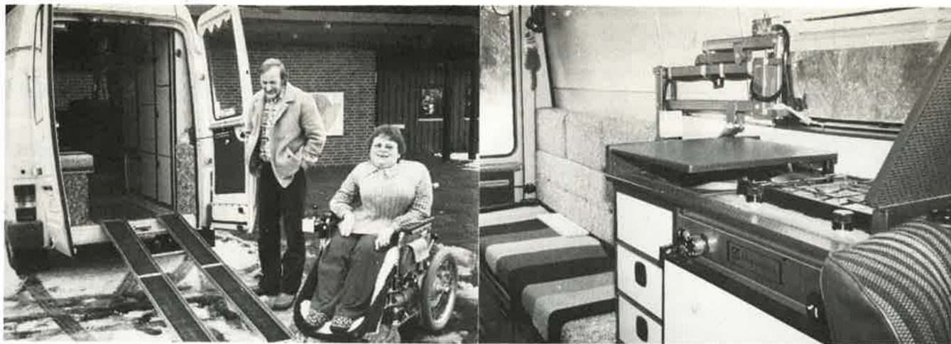
Bodil og Peder Pedersen har ombygget en varevogn til en velfungerende camping-bil. Den er udstyret med ramper, indbyggede skabe, køkken, lift og tre sovepladser.
