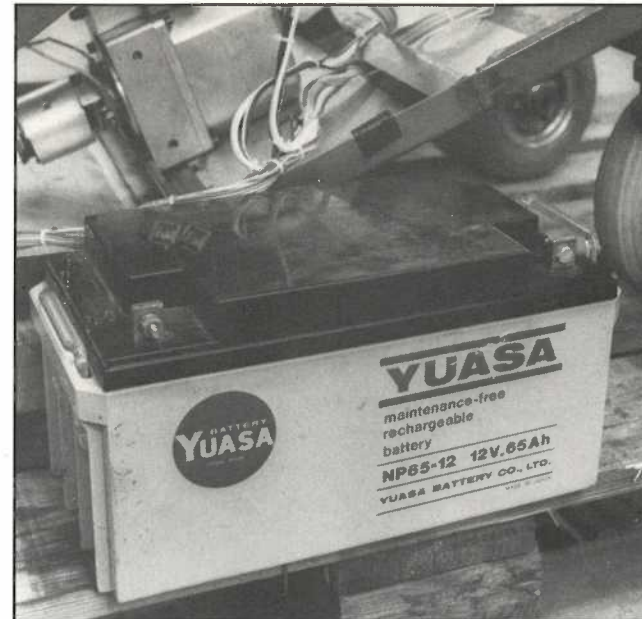
Akkumulatoren skal ikke vandpåfyldes. Og den er gastæt. Den kan både monteres på skrå og udsættes for rystelser. Godkendt til benyttelse i fly-passagerkabine. Foto: Mogens Laier.
