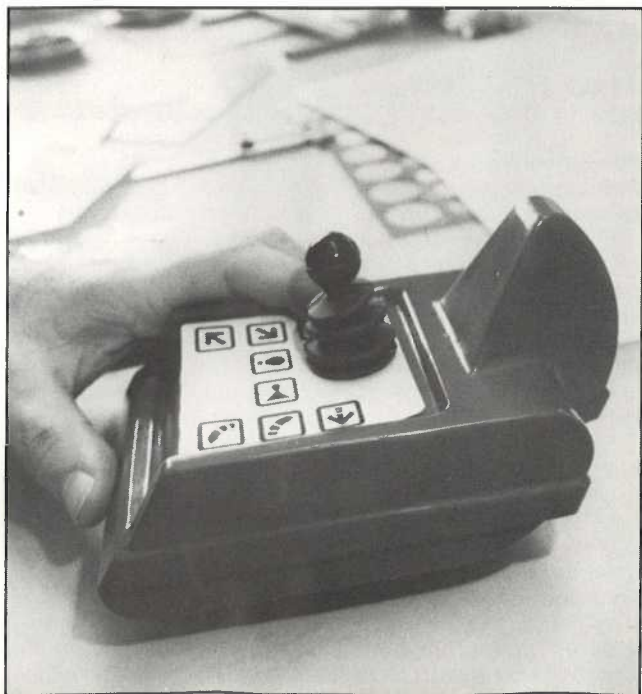
Åbent ind til stolens chassis i rustfrit stål og hydraulisk løft og sænk. De to kraftige el-motorer er monteret i et modul, der løsnes med fire bolte. Styreboksen er naturligvis vand-sikker, behagelig varm at røre ved, kan monteres i hver side. Fotos: Mogens Laier.
