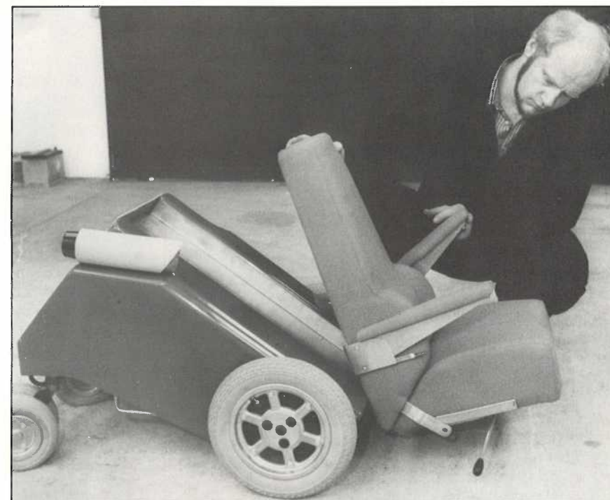
Bent Hansen har fået børne-kørestolens hydraulik til at sænke sædet til gulv- og legehøjde. Foto: Mogens Laier.
