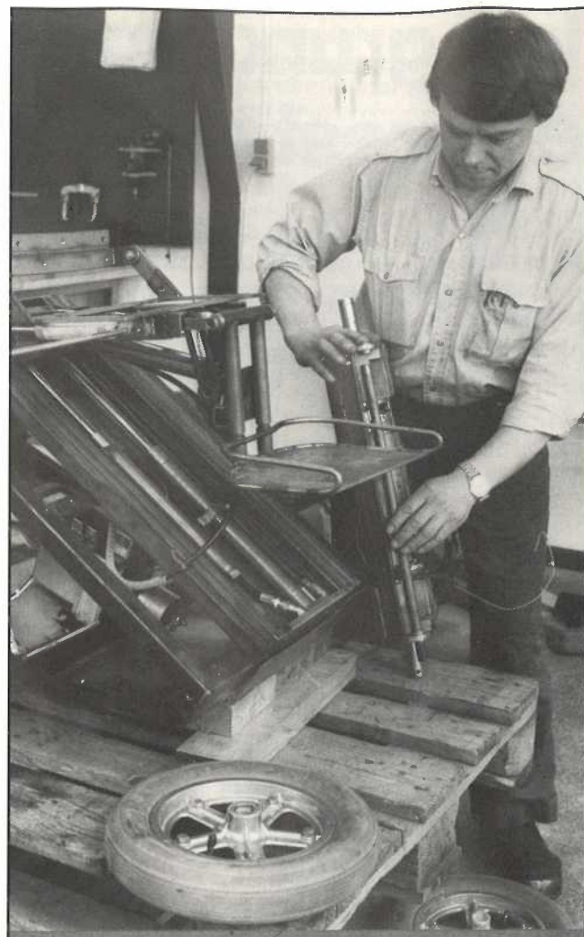
Åbent ind til stolens chassis i rustfrit stål og hydraulisk løft og sænk. De to kraftige el-motorer er monteret i et modul, der løsnes med fire bolte. Styreboksen er naturligvis vand-sikker, behagelig varm at røre ved, kan monteres i hver side. Fotos: Mogens Laier.
