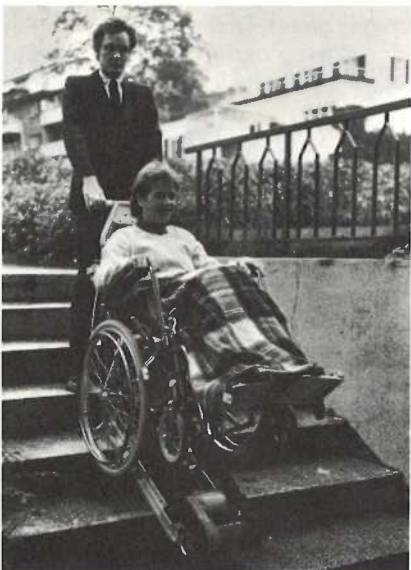
Trappetjeneren kan klare en stigning på 35 grader, og den kræver ingen kræfter hos hjælperen.
