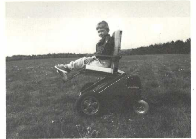
Brian Kruse afprøver hæve- og sænkemekanismen på børnekørestolen, og den ser ud til at fungere tilfredsstillende. (Kim Klastrup).
