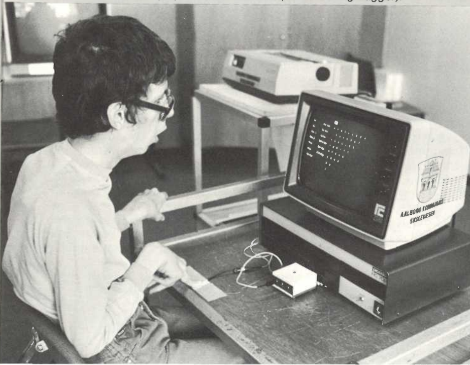
Via et stykke aluminiumsfolie klistret på en bordplade er brugeren i stand til at styre en computer ved hjælp af en CIF-kontakt. (Foto Henning Bagger).
