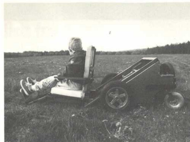
Brian Kruse afprøver hæve- og sænkemekanismen på børnekørestolen, og den ser ud til at fungere tilfredsstillende. (Kim Klastrup).
