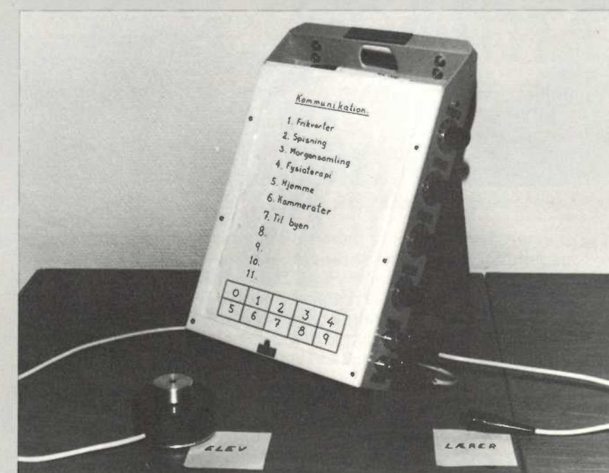
En kommunikator - udviklet på Skolen ved Kæret - som erstatning for CARBA-udstyret, der fyldte det meste af en reolvæg. Kommunikatoren kan de samme ting som CARBA-udstyret.
