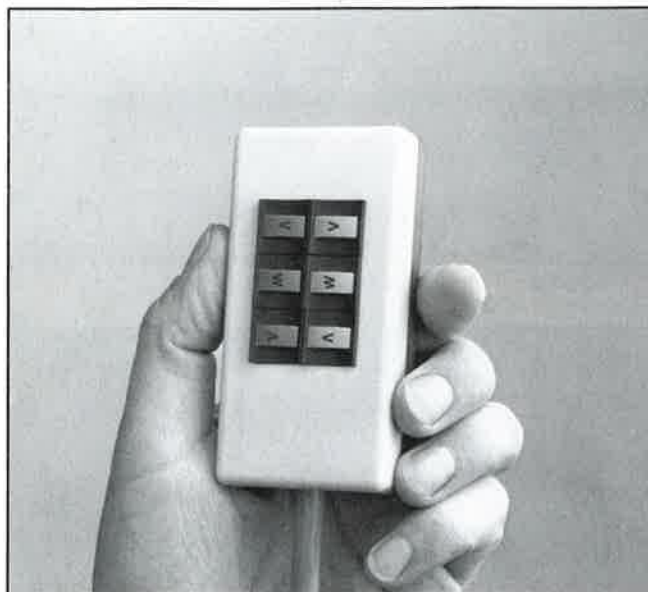
1: Med fjernbetjeningen styres det kraftige rullelagens bevægelser. Patienten kan vendes til både højre og venstre side.
