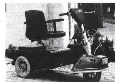
MAXI-SPORT en flot og letløbende maskine i formplast 1,4 hk el-motor.
